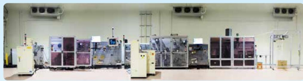
多くの人員を掛けて製造する方式であるのに比べて、バアロアでは、一つのラインでアンテナへのICモジュールの実装からタグやラベル加工、さらには様々な形状の機能性タグの加工を高速に行います。このため、年間の生産数量に対して、製造に関わる人員の総数が少なく済み、スペースも少なく済み、製造ラインは高額であっても、1ラインでの年間の生産可能な数量が多いため、RFIDタグ1つ辺りの減価償却費は極めて小さくなります。これによって国内でのRFIDタグの低コスト製造を実現しています。
